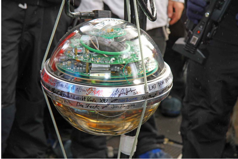
Abbildung 4: Der letzte DOM, der in das Eis herabgelassen wurde. Der PMT befindet sich an der Unterseite der Kugel. [5]
