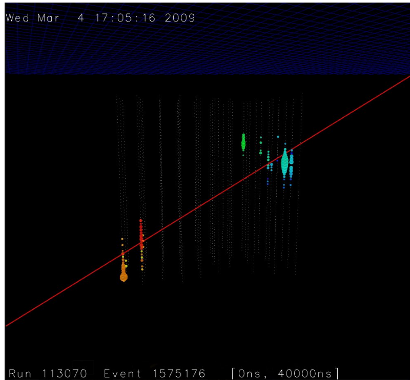
Abbildung 7: Zwei Lichtblitze die vom LineFit-Algorithmus (rote Linie) fälschlicherweise als ein aufsteigendes Teilchen erkannt werden. [5]
